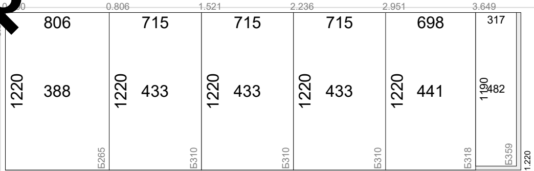
Лист №: 3 (176) Количество копий: 1 Материал: Cherrywd Размер: 4.000 x 1.220 m. Площадь листа: 4.880 sq.m. Количество деталей: 6 Отходы: 0.051 (1.0%) Маркированные остатки: 0.000 (0.0%) Длина реза: 7.637 m. Заметки: RAL 9010
